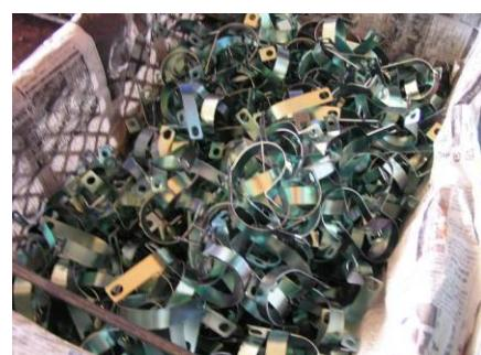
一度に大量の製品を生産することが可能なめっき処理方法ですが、単にバレルに製品を投入すれば良いわけではなく、打痕、変形、製品の混ざりや絡まり等、過去トラ等を考慮したノウハウが必要なめっき処理になります。
