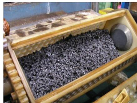
写真の製品はボルトになりますが、1つのバレルに3,500個程度のボルトを投入して、一度の処理で全ての製品にめっきを付けていき、100万個/月以上の製品を生産しています。バレルでめっきを付けた製品は、耐食性を向上させるため、化成処理を行います。
