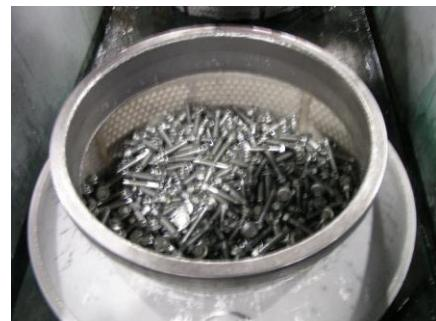
化成処理は、電気は使わず、バスケットを化成処理液内で揺動させ、化成処理液を製品に当てて化成処理被膜を形成させます。
